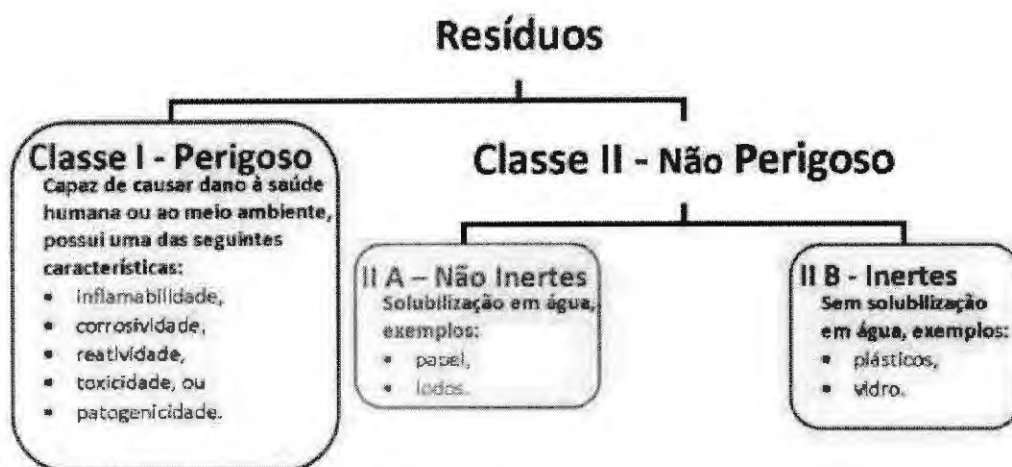
Figura 1. Classificação dos resíduos segundo a NBR 10.004:2004.
